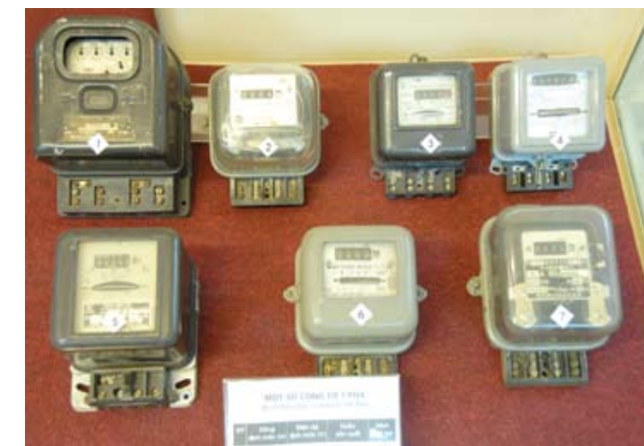
Một số công tơ 1 pha đã và đang được sử dụng tại Việt Nam
