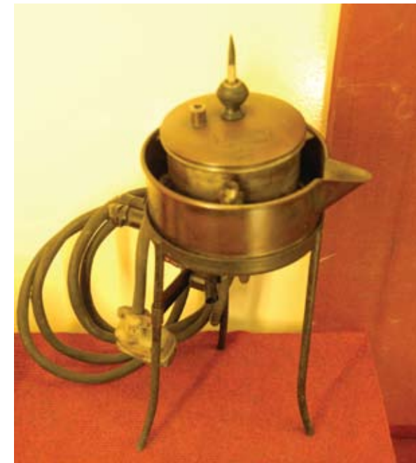
Dụng cụ thử nhiệt độ chớp cháy (Xưởng Cơ điện - Nhà máy điện Chợ Quán) - Chế tạo năm 1960, dùng xác định nhiệt độ chớp cháy của nhiên liệu và dầu bôi trơn trong phòng thí nghiệm
